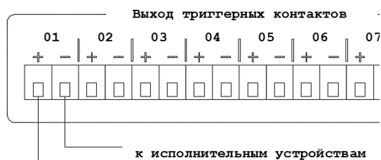
Рис. 3.5. Схема подключения внешних исполнительных устройств к LPA-PRESTA-16.
